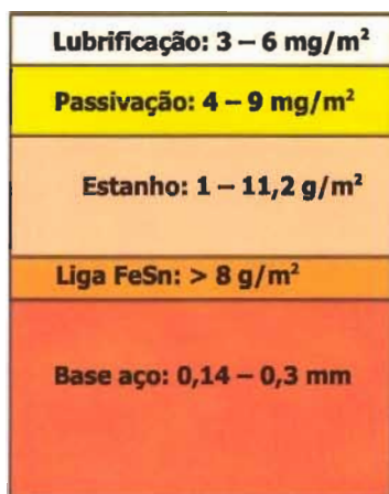
Esquema 1 - Estrutura típica da folha-de-flandres usada em embalagens para a indústria alimentar.
