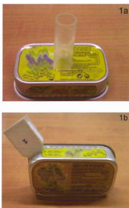
Figura 1 - Tipos de células utilizadas para os estudos de impedância.
