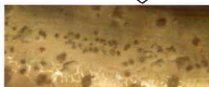
Figura 11 - Superfície exterior de uma amostra do tipo A após ensaio de nevoeiro salino e pormenor da corrosão por picadas na zona 4.
